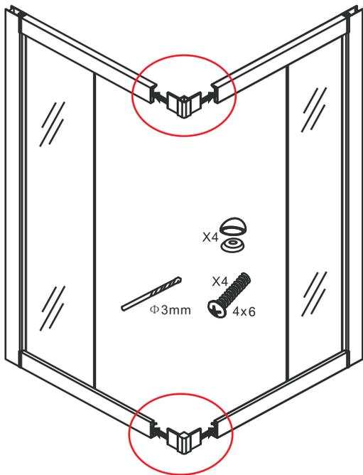
Prima di avvitare le viti che bloccano l'angolo di giunzione, inserire la rondella bianca in dotazione.
