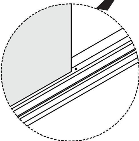
Le guide sono inserite correttamente se il foro presente nella parte centrale delle guide si trova in corrispondenza della fine del vetro.
